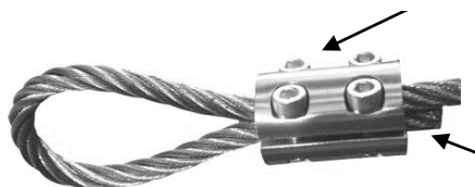
Rys. 3: Śruby w kierunku aktywnego końca liny
