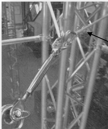
Abbildung 1: Schlinge um den Anschlagpunkt legen
